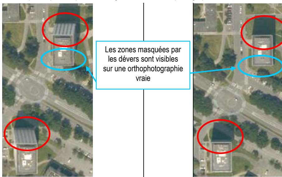
Orthophotographie classique avec apparition de dévers sur les bâtiments hauts
