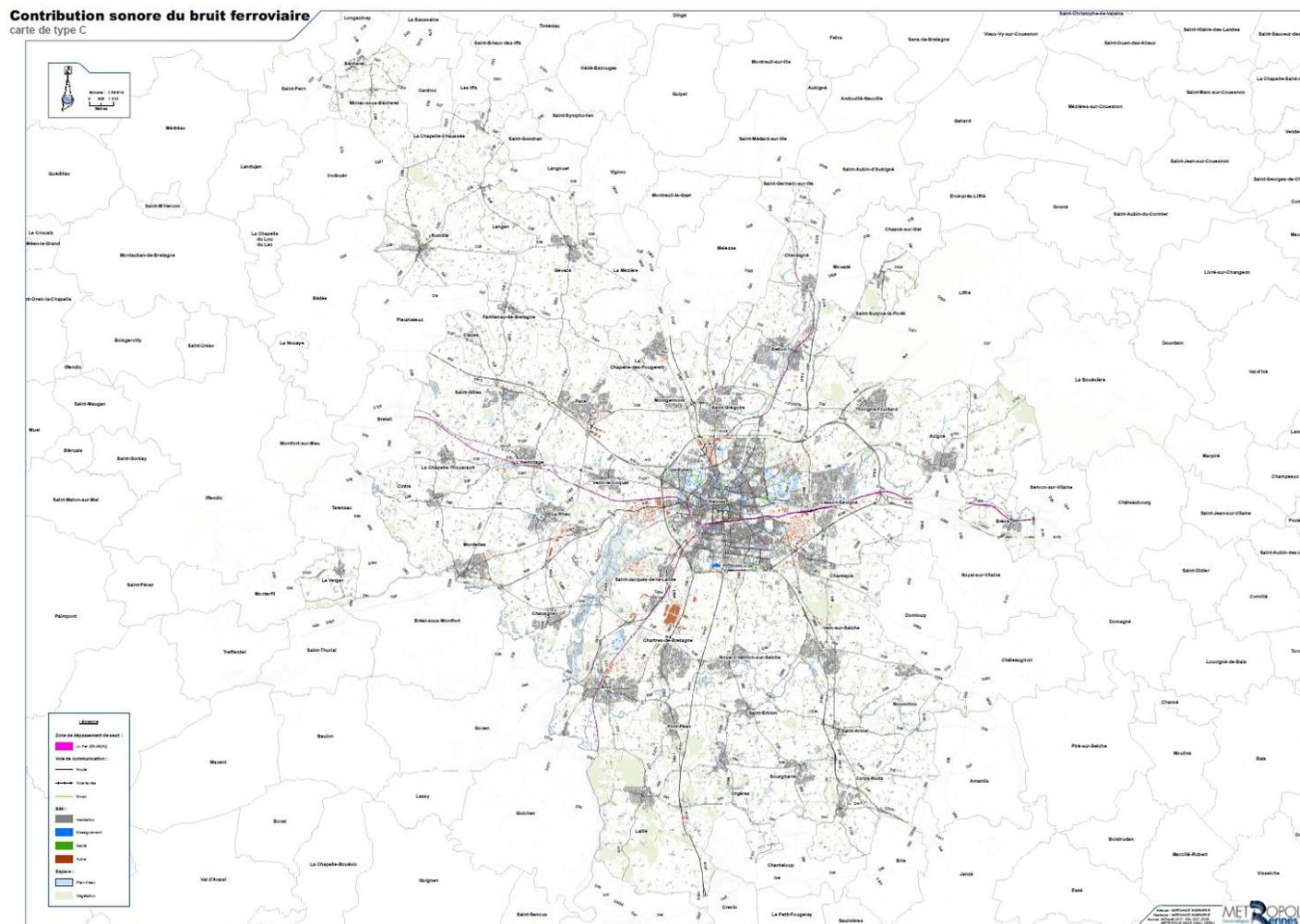
Exemple de carte des zones de dépassement de seuil du bruit ferroviaire pour l'indicateur global  $L_n$
