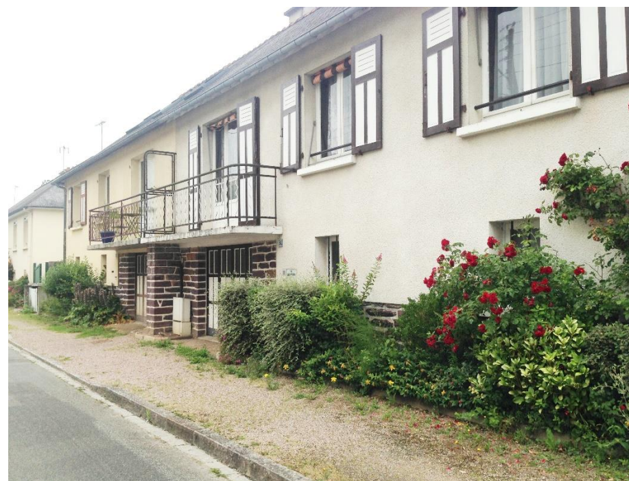
Les plantations en pieds de murs participent à la bonne santé du bâti en réduisant les remontées capillaires dans les maçonneries.
