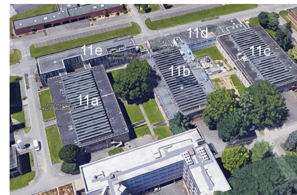
Bâtiments 11a, 11b et 11c – les sheds en toiture : éclairage zénithal
